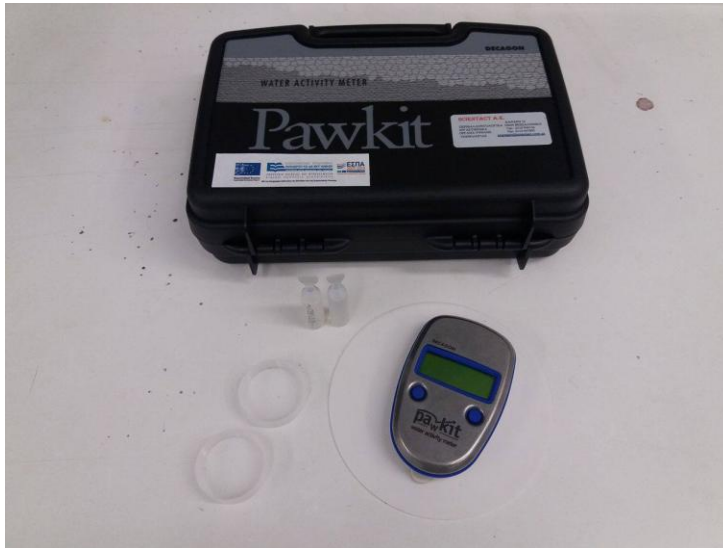
Εικόνα 2.3 Μετρητής ενεργότητας νερού ( a_w )
