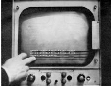
Εικόνα 2 - Ελεγκτής εναέριας κυκλοφορίας που δέχεται είσοδο μέσω αφής [2]
