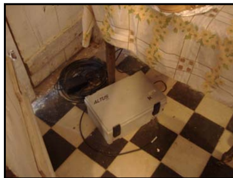
Εικόνα 4.19: α) Η εκκλησία του Αγ. Ιωάννη όπου έχει εγκατασταθεί ο σταθμός του Γαλαξειδίου και β) η θέση του επιταχυνσιογράφου μέσα στο ιερό της εκκλησίας.
