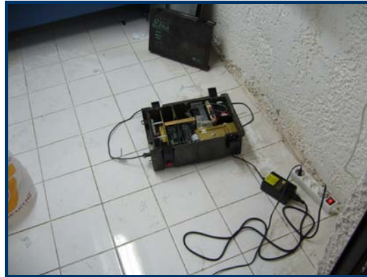
Εικόνα 4.25: Η θέση του επιταχυνσιογράφου σε ειδικό χώρο του υπογείου του δημαρχείου του Λουτρακίου.
