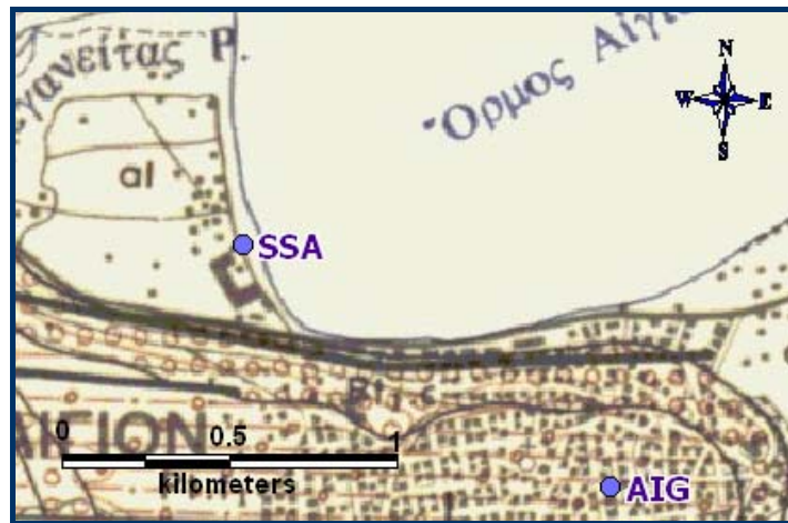
Εικόνα 4.7: Γεωλογικός χάρτης της περιοχής του Αιγίου (Ι.Γ.Μ.Ε. , Φύλλο Αμυδαλέα , 1:50000). Στο χάρτη παρουσιάζονται οι θέσεις των σταθμών του Αιγίου και της διάταξης CORSSA , που βρίσκεται κοντά στο λιμάνι της πόλης. Ο σχηματισμός al αντιστοιχεί σε Ολοκαινικές αλλουβιακές αποθέσεις και ο Pt1-c στα κροκαλοπαγή του Αν. Πλειστοκαίνου.
