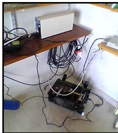
Εικόνα 4.17: α) Το κοινοτικό γραφείο όπου είναι εγκατεστημένος ο σταθμός των Τριζονίων και β) η θέση του επιταχυνσιογράφου στο δάπεδο του εσωτερικού του γραφείου , συνδεδεμένου με συσκευή UPS και modem.
