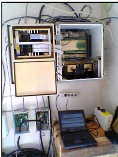
Εικόνα 4.31: Το κεντρικό καταγραφικό σύστημα της διάταξης CORSSA τύπου Mt . Whitney της εταιρίας Kinematics.
