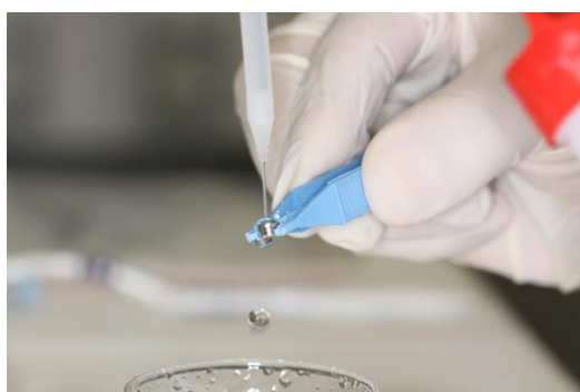
Εικόνες 16,17. Η απομάκρυνση του σαπουνιού από τα δοκίμια με συνεχή εκροή απιονισμένου H 2 O (2 φορές).
