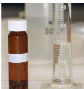
Εικόνες 18-20. Η εμφύσηση των δοκιμών σε 20 ml διαλύματος αιθανόλης 96% και η τοποθέτησή τους σε συσκευή υπερήχων (Ultrasonic Tuttnauer, USA, Co) για 15 min.
