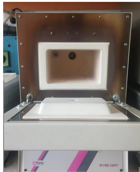
Εικόνες 4,5. Η ειδική συσκευή φούρνου (Sirio Dental Division, Italy), στην οποία πραγματοποιήθηκε η διαδικασία αποκύρωσης στους 880 °C για 3 ώρες.
