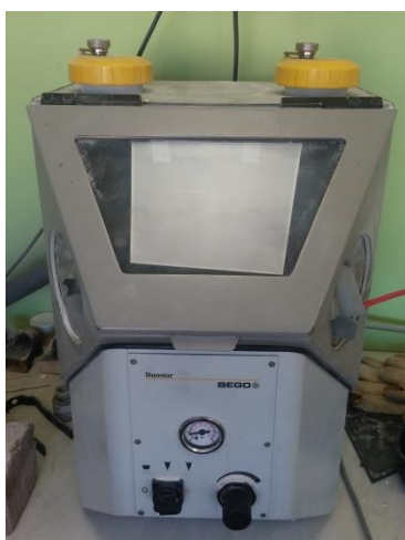
Εικόνα 9. Συσκευή αμμοβόλησης των δοκιμίων (Bego, Bremen, Germany) με οξειδία αλουμινίου ( Al_2O_3 ) 50 \mu m .
