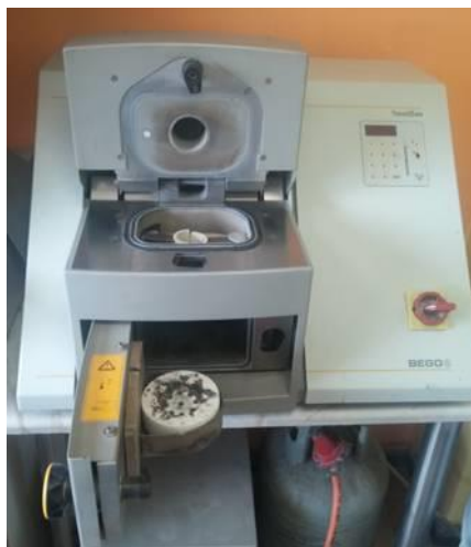
Εικόνες 6,7. Η επαγωγική φρόντα (Bego, Bremen, Germany), στην οποία πραγματοποιήθηκε η διαδικασία χύτευσης.
