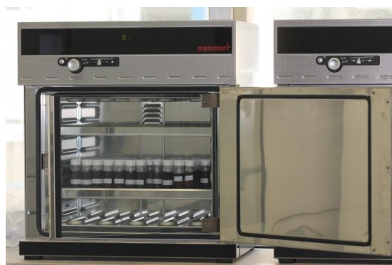
Εικόνα 26. Ο ειδικός θερμοστάτης (Memmert GmbH & Co) σε συνθήκες ατμόσφαιρας 5 % CO 2 και θερμοκρασίας 37°C με τοποθετημένους τους δοκιμαστικούς σωλήνες σε αυτόν.
