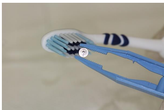
Εικόνες 14,15. Ο καθαρισμός των δοκιμών με μαλακή οδοντόβουρτσα και ειδικό σαπούνι (Alconox, Inc. New York, N.Y.)
