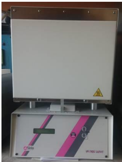
Εικόνες 4,5. Η ειδική συσκευή φούρνου (Sirio Dental Division, Italy), στην οποία πραγματοποιήθηκε η διαδικασία αποκύρωσης στους 880 °C για 3 ώρες.
