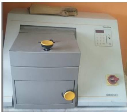
Εικόνες 6,7. Η επαγωγική φρόντα (Bego, Bremen, Germany), στην οποία πραγματοποιήθηκε η διαδικασία χύτευσης.
