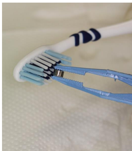
Εικόνες 14,15. Ο καθαρισμός των δοκιμών με μαλακή οδοντόβουρτσα και ειδικό σαπούνι (Alconox, Inc. New York, N.Y.)
