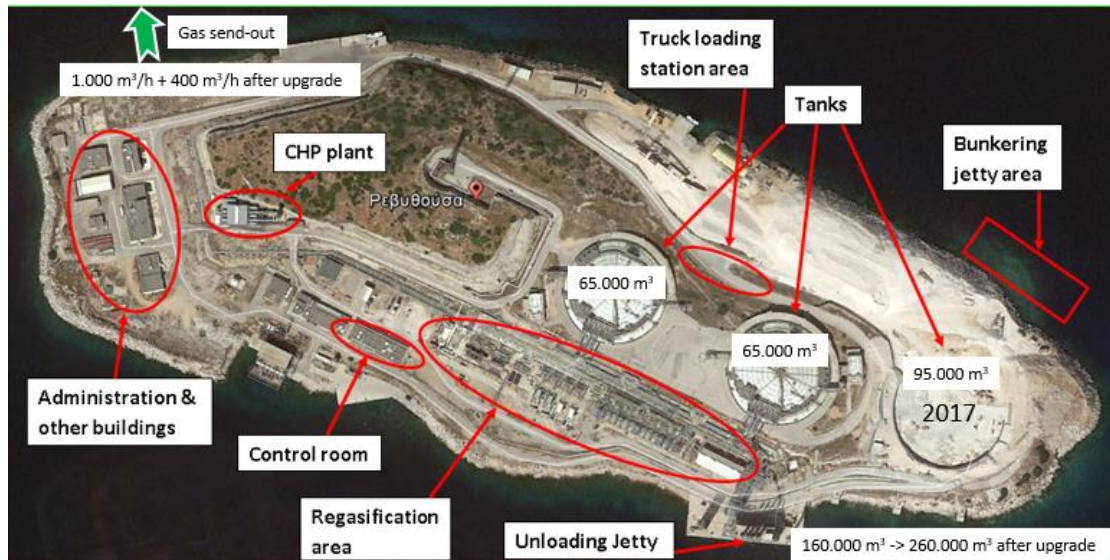
Εικόνα 2.8 : Περιγραφή της Ρεβουσσας (Πηγή: ΔΕΣΦΑ, ο ρόλος της Ρεβουσσας στην περιφερειακή διανομή ναυτιλιακού καυσίμου LNG, Ιωσήφ Φλωρεντίν, Ετήσια Συνάντηση Ναυτικής Τεχνολογίας 2016)
