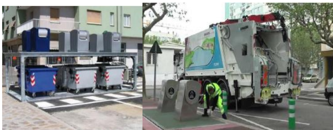
Εικόνα 3.18. Συστήματα Υπόγειων Κάδων
