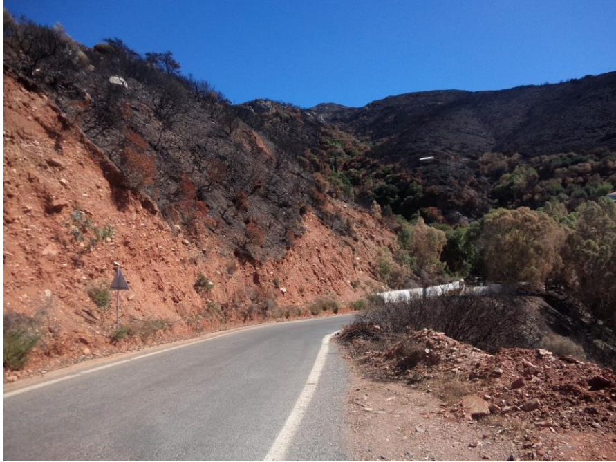
Εικόνα 3.32. Απουσία αναβαθμών στην βόρεια είσοδο του Αγίου Νικολάου. Η περιοχή δομείται από τεταρτογενείς κλάστικους σχηματισμούς που είναι από την φύση τους πιο ευδιάβρωτοι, μετά την πυρκαγιά το έδαφος αποσπάται εύκολα, ειδικά σε περιοχές με μεγάλες μορφολογικές κλίσεις (Λέκκας et al., 2015)
