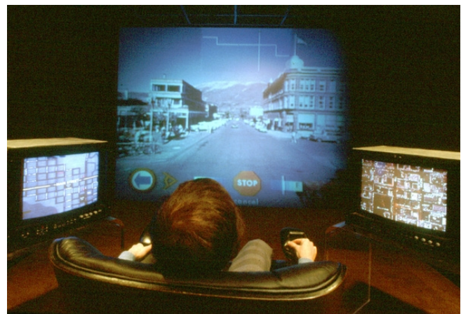
Illustration 4: Το interface του Aspen Movie Map. Λιτό, με φυσιολογικές λειτουργίες όπως 'μπροστά', 'πίσω', 'στροφή' και 'stop'
