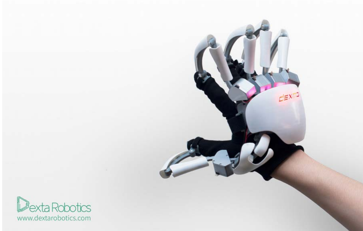
Εικόνα 10: Το γάντι εξωσκελετού Dexmo που προσφέρει ανάδραση δύναμης για κάθε ξεχωριστό δάχτυλο
