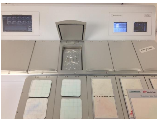
Εικόνα 2.9 Επωαστικοί κλίβανοι. Ανω: θάλαμος εργασίας emCell-S. Μέσον: επιτραπέζιος κλίβανος Cook MINC™-1000. Κάτω αριστερά: επιτραπέζιος κλίβανος IKS Xilatrix. Κάτω δεξιά: κλίβανος προθέρμανσης Memmert.
