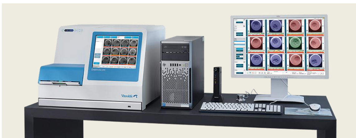
Εικόνα 1.20 Σύστημα απεικόνισης με χρονοδιολίσθηση (Embryoscope®). Το σύστημα αποτελείται από τη μονάδα επώασης και μικροφωτογράφισης (αριστερά), τη μονάδα καταγραφής (στο κέντρο) και τη μονάδα ανάλυσης και επεξεργασίας της εικόνας (δεξιά).
