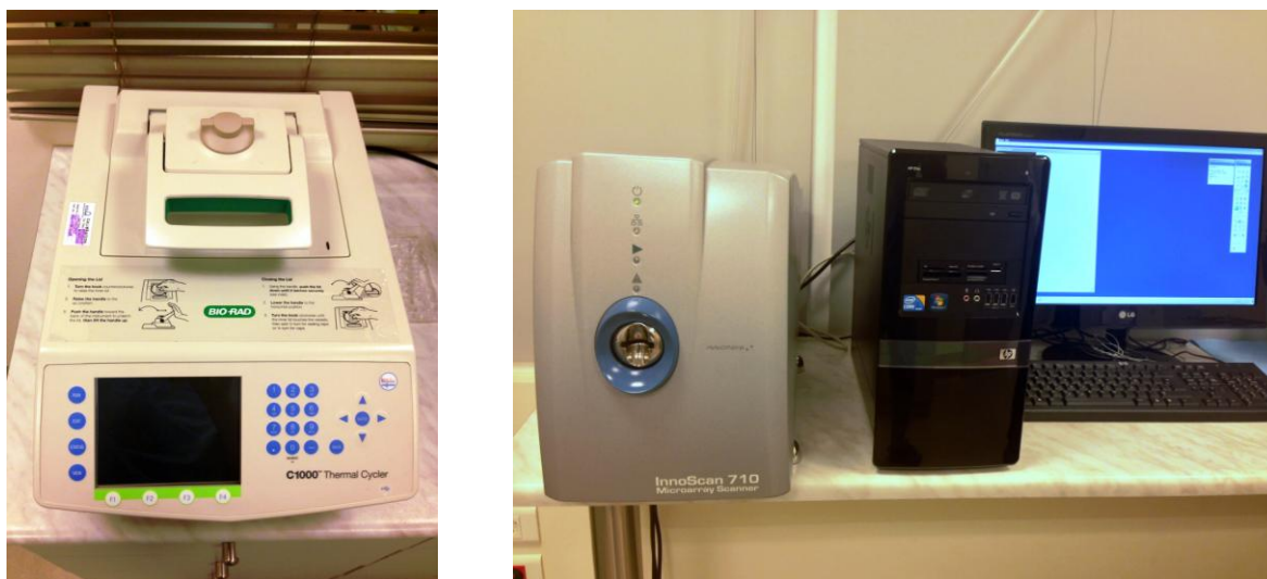
Εικόνα 1.24 Ειδικός εξοπλισμός για τον συγκριτικό γονιδιωματικό υβριδισμό σε μικροσυστοιχίες DNA (aCGH). Αριστερά: θερμοκυκλοποιητής για PCR. Δεξιά: σαρωτής πλακιδίων και μονάδα επεξεργασίας των αποτελεσμάτων.
