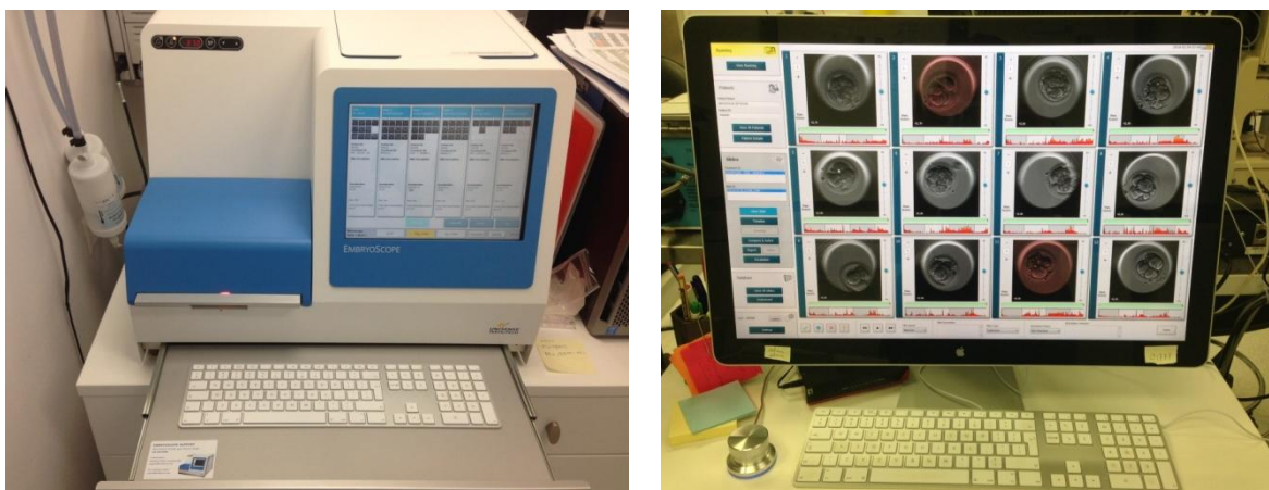
Εικόνα 2.16 Παρακολούθηση καλλιέργειών στο σύστημα χρονοδιολίσθησης Embryoscope®. Αριστερά: το εγκατεστημένο σύστημα στο εργαστήριο. Δεξιά: έλεγχος της αναπτυξιακής πορείας.
