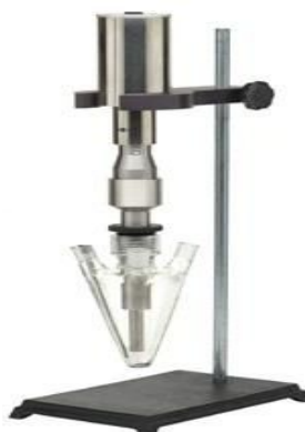
Εικόνα 2.1.: Συσκευή δημιουργίας υπερήχων (US) με Probe της Sonics & Materials (USA).
