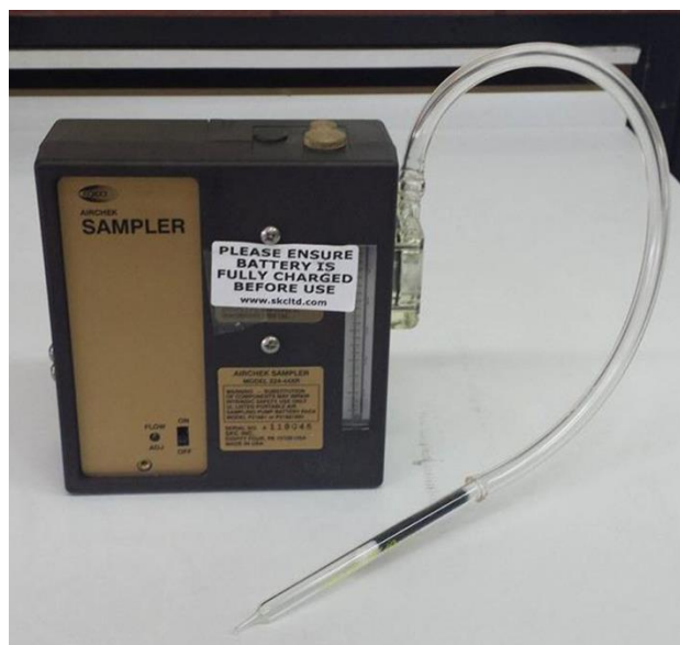
Εικόνα 6.3.1 : Αντλία συνδεδεμένη με σωλήνα πληρωμένο με ενεργό άνθρακα.
