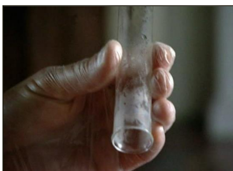
Υδρατμοί σχηματίζονται εσωτερικά στα τοιχώματα του δοκιμαστικού σωλήνα μετά την ανάφλεξη του υδρογόνου
