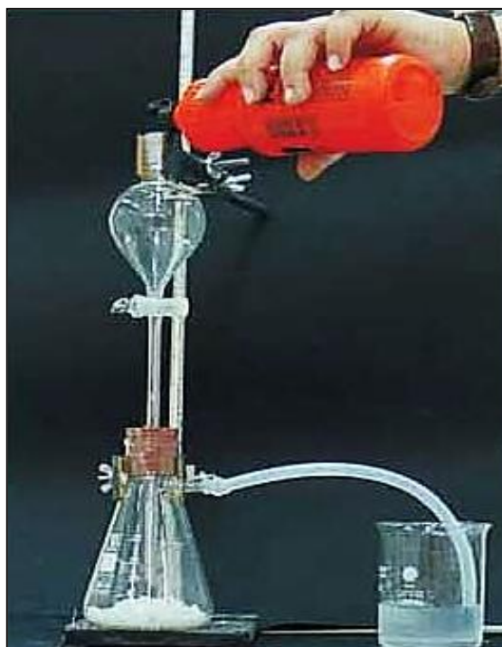
Εικ. 46: Επίδραση υδροχλωρικού οξέος σε ανθρακικό ασβέστιο και διαβίβαση του παραγόμενου αερίου σε ασβεστό-νερο
