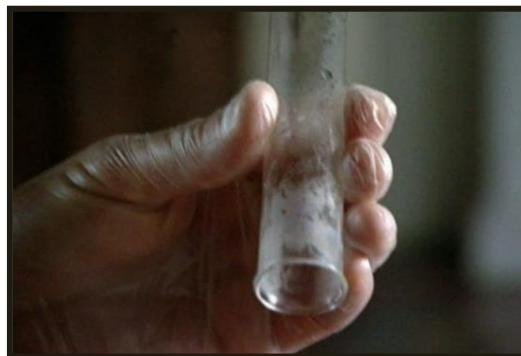
β. Υδρατμοί σχηματίζονται εσωτερικά στα τοιχώματα του δοκιμαστικού σωλήνα
