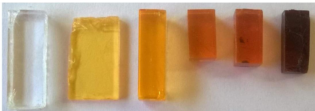
Σχήμα 35: Δείγματα LiF που έχουν δεχθεί διαφορετικές δόσεις ακτινοβολίας γ. Το δείγμα στο αριστερό άκρο είναι διαφανές γιατί δεν έχει ακτινοβοληθεί. Από αριστερά προς τα δεξιά αυξάνεται η δόση ακτινοβολίας και το χρώμα μεταβάλλεται.
