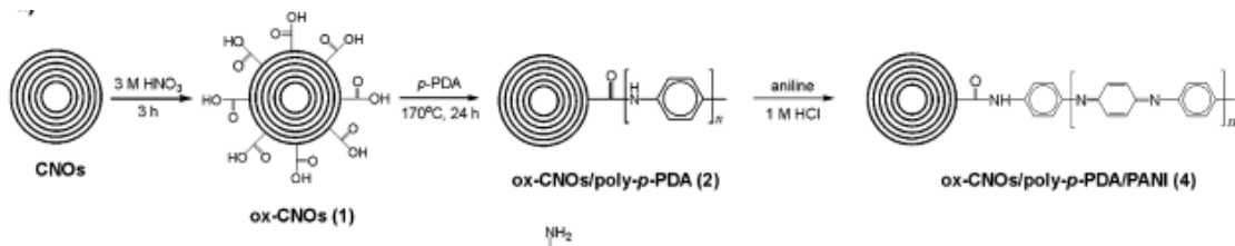
Εικόνα 8: Εμπλουτισμός της επιφάνειας του CNO με p-PDA [PMP 12]
