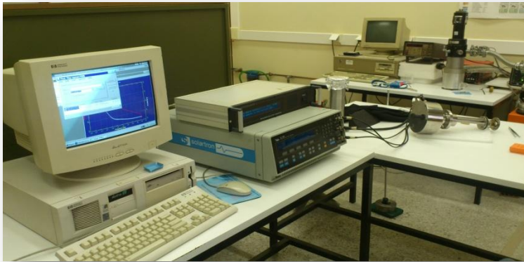
Εικόνα 16: Καταγραφή και αποθήκευση μετρήσεων. Solartron Frequency Response Analyzer (FRA)
