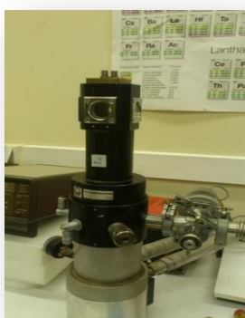
Εικόνα 12: Κρυστάτης, όπου έγινε η τοποθέτηση του πυκνωτή
