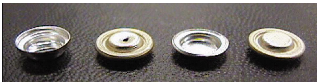
Εικόνα A4: Διαφορετικοί τύποι pan που χρησιμοποιούνται στη Διαφορική Θερμιδομετρία Σάρωσης (ανοιχτός, με οπή, καλυμμένος και σφραγισμένος) (Clas et al., 1999).
