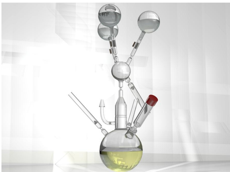
Εικόνα 2: Σχηματική αναπαράσταση της συσκευής ανακρυσταλλώσεων των μονομερών NCAs με την χρήση τεχνικών υψηλού κενού.
