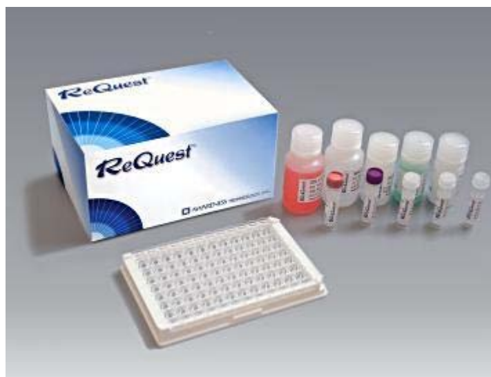
Εικόνα 15: Ένα τυπικό kit ELISA (της εταιρείας ReQuest). Φαίνεται η πλάκα μικροτιτλοδότησης ή πλάκα ELISA, τα διαλύματα των conjugate, stop, wash, enzyme και substrate, καθώς και τα μικρά σωληνάρια των controls και των calibrators.
