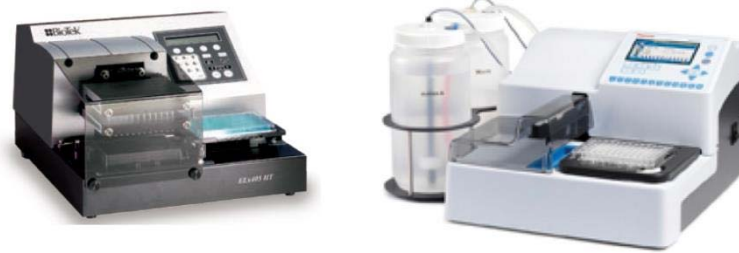
Εικόνα 16: Αυτόματα πλυστικά ELISA διαφόρων εταιρειών (Biotek, Thermo). Αν και η έκπλυση των πλακών ELISA μπορεί να γίνει και χειρονακτικά με τη βοήθεια πιπέττας, το αυτόματο πλύσιμο είναι γρήγορο και αποτελεσματικό.
