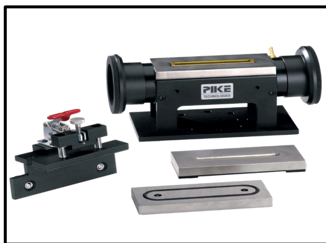
Εικόνα 4.2.2.: Βάση με πλάκα κρυστάλλου ATR
