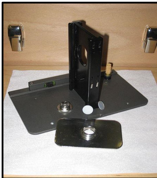
Εικόνα 4.4.1.: Μεταλλικός υποδοχέας χαπιού KBr
