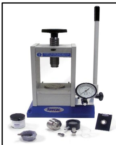
Εικόνα 3.3.2.1.: Πρέσα και καλούπι για παρασκευή δισκίου KBr
