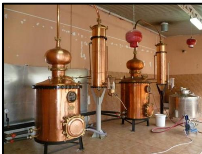
Εικόνα 1.2.1.2.: Σύγχρονη συσκευή απόσταξης με κλασματική στήλη.
