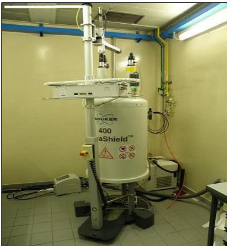
Εικόνα 4.8.1.: Φασματογράφος N.M.R. Bruker Snif - Ultrashield 400 MHz
