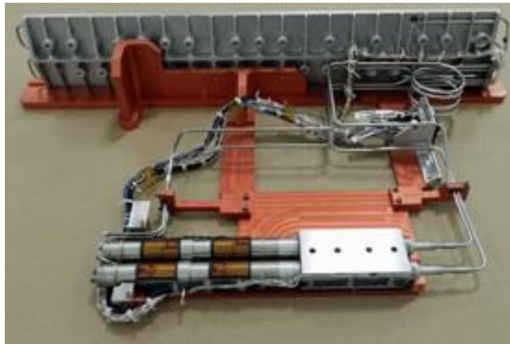
Εικ. 26 Βρόγχος ψύξεως Πηγή: milsatmagazine.com (Ημερ. Ανάκτησης: 7/2/2017, goo.gl/6zAj3v )
