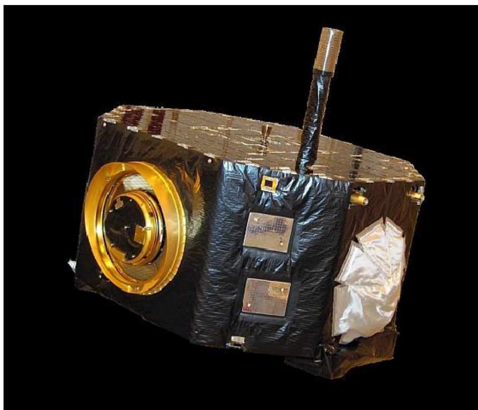
Εικ. 28 Δορυφόρος IBEX. Διακρίνεται ο αισθητήρας IBEX-Lo Πηγή: eoPortal (Ημερ. Ανάκτησης: 7/2/2017, goo.gl/Kpt3Bc )
