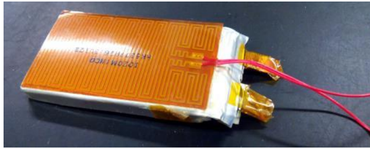
Εικ. 25 Στοιχείο θέρμανσης μπαταρίας Πηγή: University De Liege – Μεταπτυχιακή Διατριβή Lionel Jacques (Ημερ. Ανάκτησης: 7/2/2017, goo.gl/6q1BIC )
