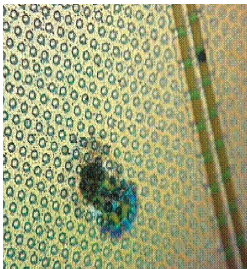
Εικ. 22 SEE – SEGR: Single Event Gate Rapture σε MOSFET ισχύος Πηγή: Mauer et al, 2008:21
