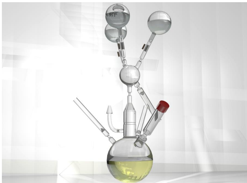
Σχήμα 2.8: Σχηματική αναπαράσταση της συσκευής ανακρυσταλλώσεων των μονομερών NCAs με την χρήση τεχνικών υψηλού κενού.
