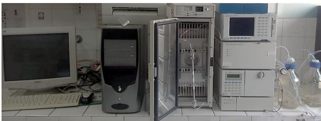
Σχήμα 5.1. Διάταξη HPLC που χρησιμοποιήθηκε στην παρούσα διπλωματική εργασία.
