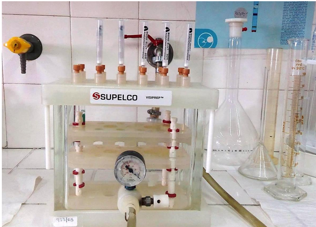
Σχήμα 11.10. Απεικόνιση συσκευής SPE, με μικροστήλες πακτωμένες με MIP(6-sulfa), που χρησιμοποιήθηκαν στο εργαστήριο.
