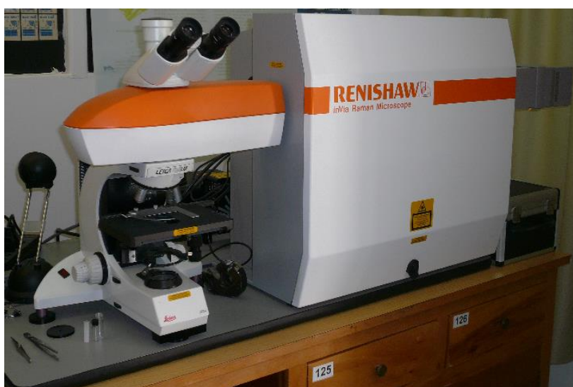
Σχήμα 2.11: Φασματόμετρο διασποράς Renishaw Invia-Reflex του εργαστηρίου Raman του Ε.Κ.Ε.Φ.Ε. «Δημόκριτος».
