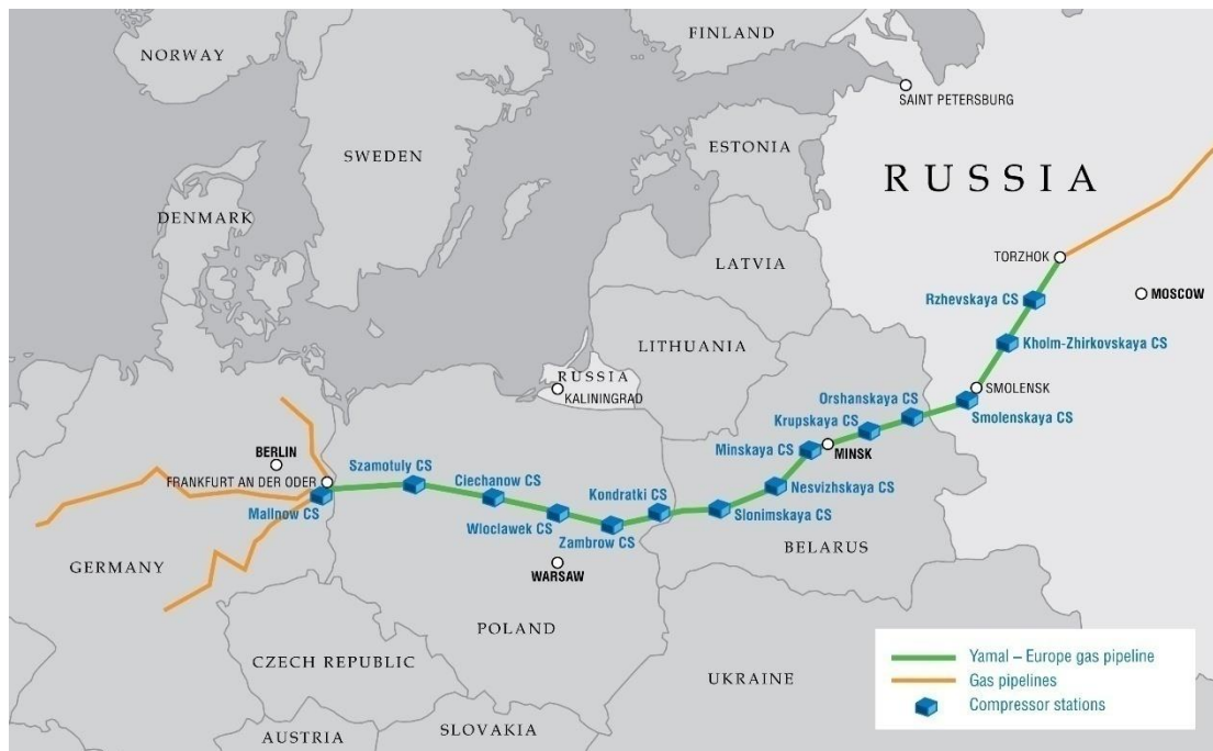
Εικ 6. Ο αγωγός Yamal - Europe, (πράσινο χρώμα) και οι σταθμοί του (μπλε χρώμα). Έτεροι αγωγοί αερίου (πορτοκαλί χρώμα) ( Gazprom, επίσημη ιστοσελίδα Gazprom.com).
