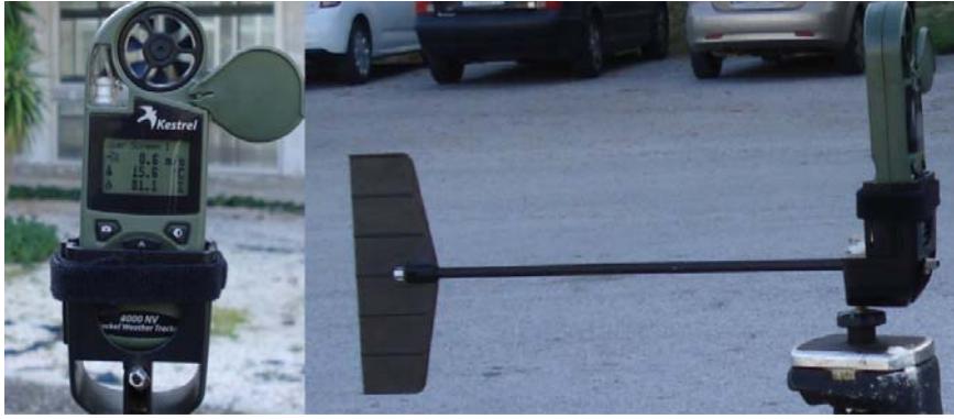
Εικόνα 5.2. Ο φορητός μετεωρολογικός σταθμός Kestrel 4000 NV Pocket Weather Tracker.
