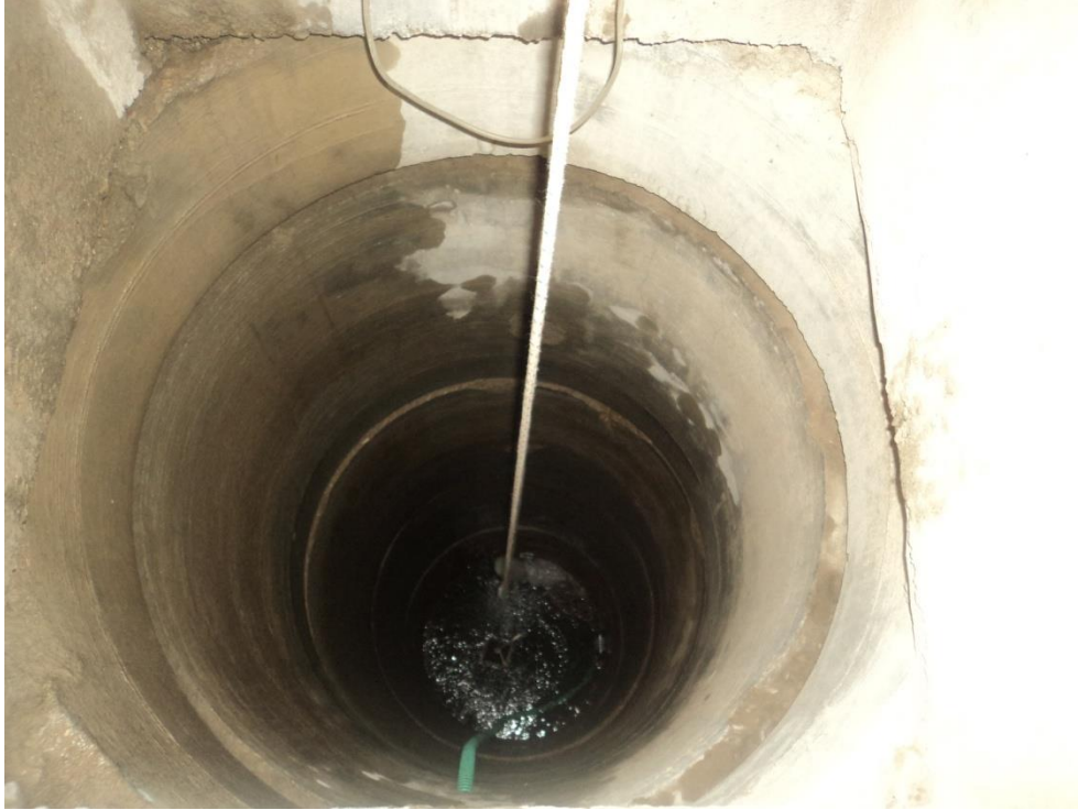
Εικόνα 12: Αναβράζουσα «όξινη πηγή» λόγω διαφυγής διοξειδίου του άνθρακα ( \text{CO}_2 ) στην περιοχή Ιτέα. Βάθος γεώτρησης περίπου 100 μέτρα και στάθμη νερού στα 60 μέτρα. Θερμοκρασία νερού T=15,3^\circ \text{C} και \text{pH}=5,65 . C=1.094\text{Mc} (αγωγιμότητα) και \text{EH}=191,2 .
