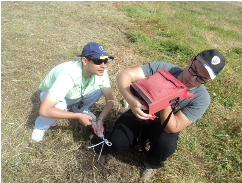
Εικόνα 20: Μέτρηση εκροής CO 2 στην περιοχή μελέτης από βάθος 60 εκατοστά εντός του εδάφους
