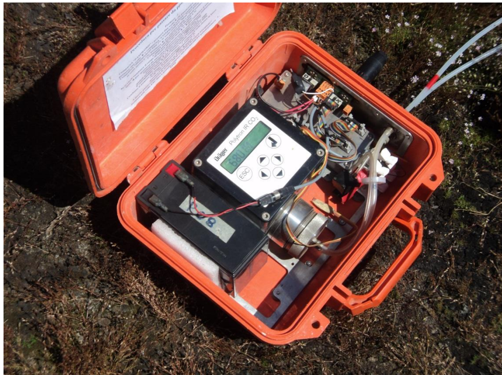
Εικόνα 18: Ειδικό όργανο για την επιτόπου μέτρηση εκροής του CO 2 (τύπος URAGER POLYTRON IR)
