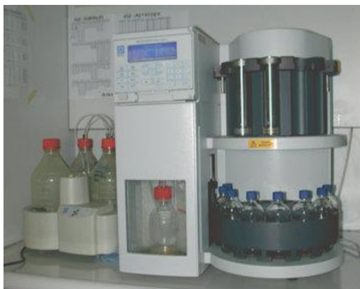
Εικόνα 25. Συσκευή επιταχυνόμενης εκχύλισης (DIONEX ASE 300)
