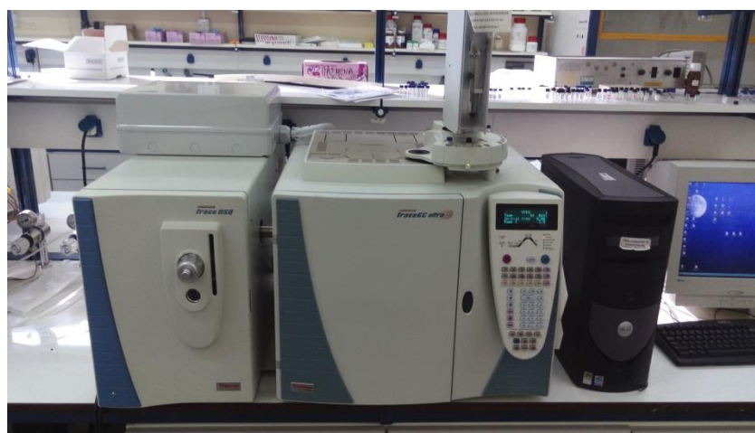
Εικόνα 26. Συσκευή αέριας χρωματογραφίας με φασματομετρία μάζας για τη μελέτη των δειγμάτων με SPME
