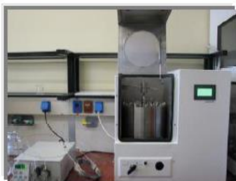
Εικόνα 27.Συσκευή κατανομής με φυγοκέντριση Kromaton FCPC
