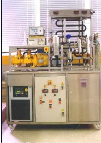
Εικόνα 20. Η εργαστηριακή συσκευή υπερκρίσιμης εκχύλισης, SFE-500.
