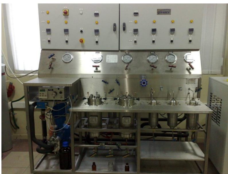
Εικόνα 23. Συσκευή Υπερκρίσιμης Εκχύλισης SFE-1-2
