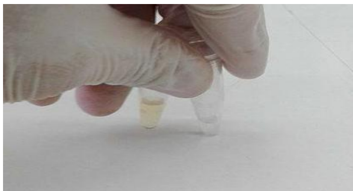
Εικόνα 23: Αριστερά το υγρό αναπλήρωσης και δεξιά ο συμπυκνωμένος ατμός από το ηλεκτρονικό τσιγάρο
