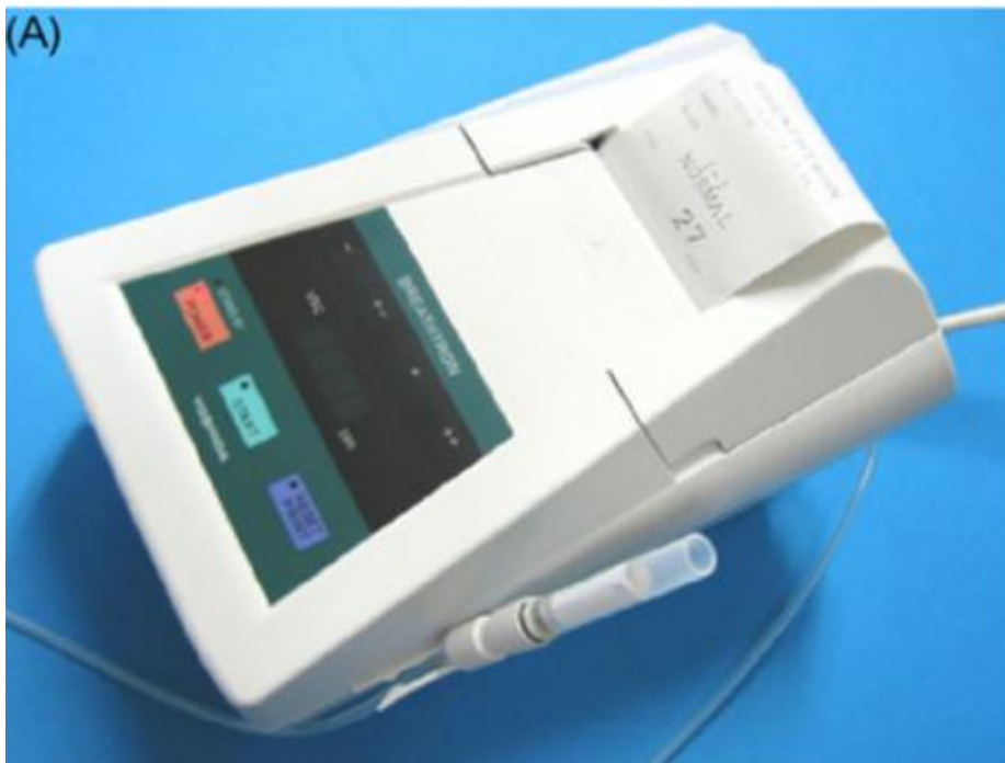
Εικ. 20: Η συσκευή ανίχνευσης πτητικών θειούχων ενώσεων με την εμπορική ονομασία Breathron™ (Tanda N και συν. 2007)
