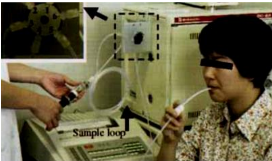
Εικ. 18: Συσσκευή αερίου χρωματογραφίας κατά τη λήψη δείγματος (Murata T και συν. 2002)
