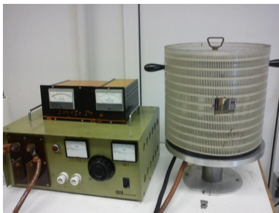
Εικόνα 5.2: Θερμικός εξαχνωτής με τον οποίο γίνεται η εναπόθεση του Αλουμινίου
