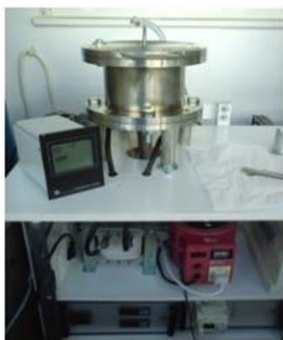
Εικόνα 5.1: (α) Σχηματική αναπαράσταση συστήματος χημικής εναπόθεσης από ατμό με θερμαινόμενο νήμα, (β) εικόνα του συστήματος HW-CVD και (γ) εικόνα του εσωτερικού του αντιδραστήρα
