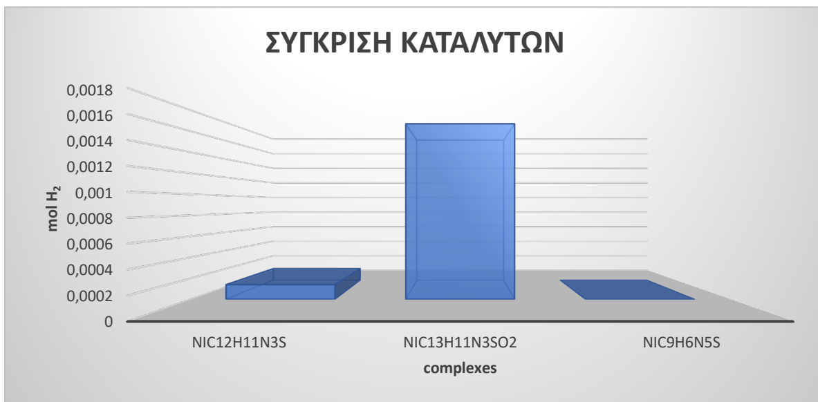
Σχήμα 97. Συγκριτικό γράφημα των τριών συμπλόκων ως καταλύτες σε σχέση με τα μέγιστα \text{mol H}_2 των συστημάτων του.
