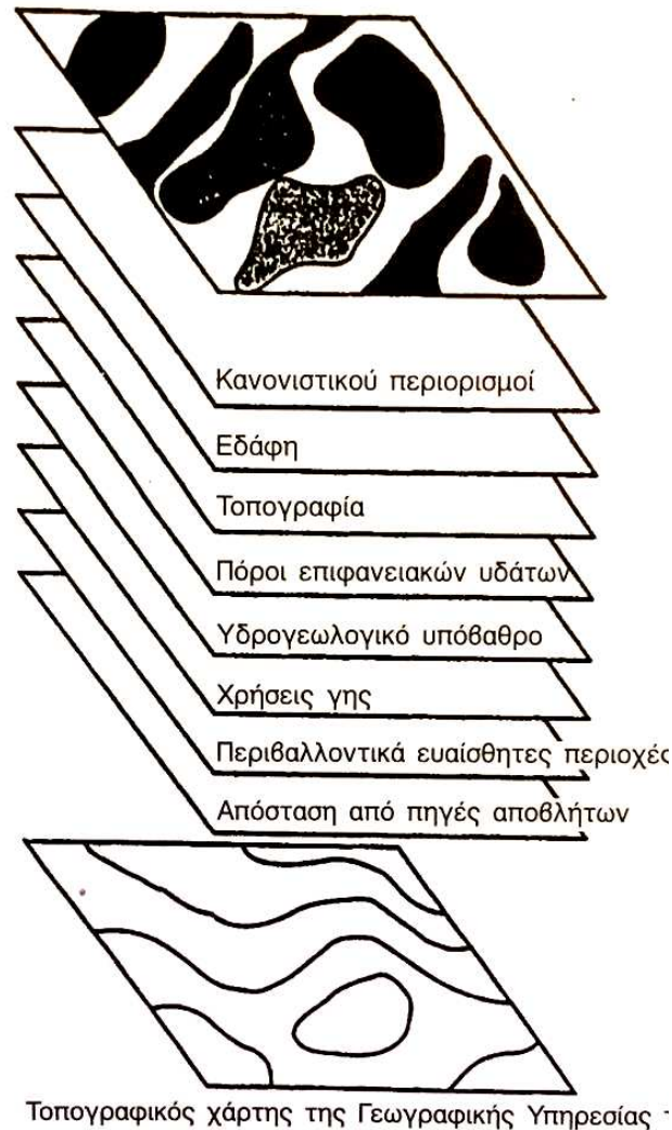
Εικόνα 2.11. Πολυεπίπεδοι στρωματικοί χάρτες διαφόρων κριτηρίων που απαιτούνται για την επιλογή πιθανών θέσεων για ΧΥΤΑ (από Barlaz et al, 1989) Πηγή: Tchobanoglous, Kreith, Εγχειρίδιο διαχείρισης στερεών αποβλήτων
