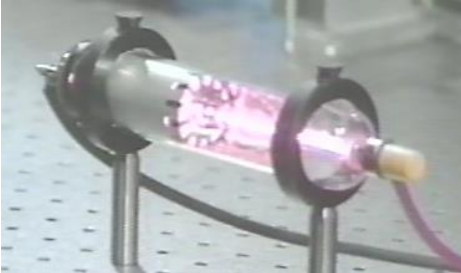
Εικόνα 15. Λυχνία laser HeNe με εσωτερικά κάτοπτρα προσαρτημένα στα παράθυρα.
