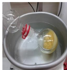
Εικόνα Β. 6. Συμπύκνωση κολοφωνίου χωρίς πολυμερές
