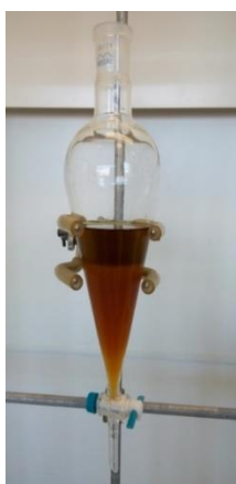
Εικόνα B. 27. Υγρή-υγρή εκχύλιση του μεθανολικού εκχυλίσματος καρπών
