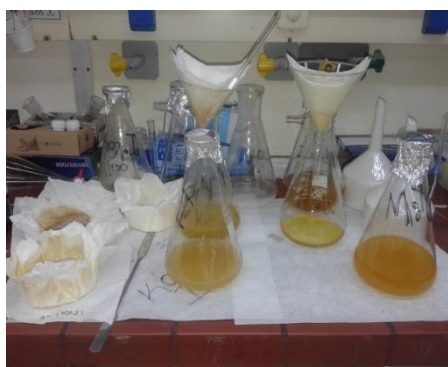
Εικόνα Β. 5. Διήθηση μαστίχας/ κολοφωνίου για την παραλαβή πολυμερούς
