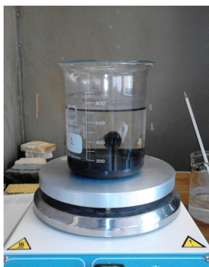
Εικόνα 39: Καθίζηση δείγματος μετά από 24 ώρες.
