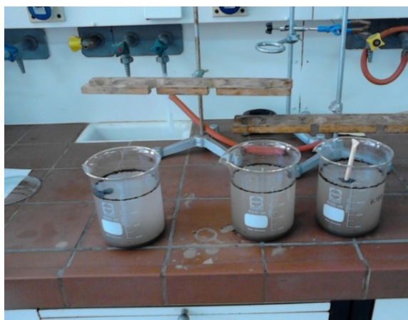
Εικόνα 37: Ποτήρια ζέσεως με ιπτάμενη τέφρα και διάλυμα NaOH.
