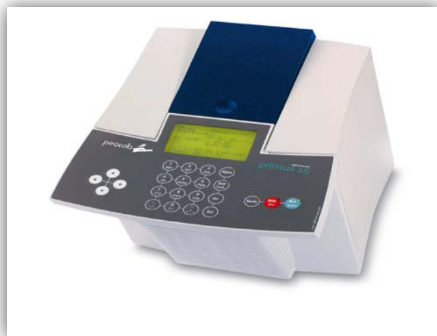
Εικόνα 7.6: Σχηματική παράσταση του θερμικού κυκλοποιητή Primus 25 της MWG ( www.coleparmer.com ).
