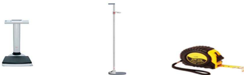
Εικόνα 3.4 - Όργανα μέτρησης: ζυγομετρητή Seca 710 (Hamburg, Germany) για την αξιολόγηση βάρους, αναστημόμετρο Seca 208 (Hamburg, Germany) για την αξιολόγηση του αναστήματος, και μετροταινία για την αξιολόγηση του καθιστού αναστήματος.
