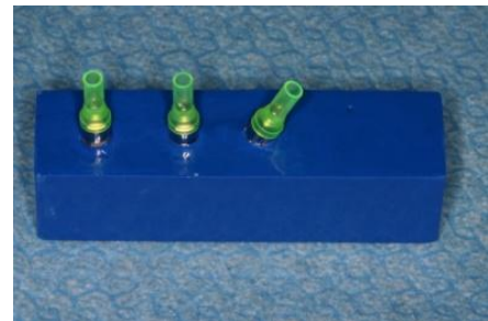
Εικ.6. Σωληνίσκοι κήρω- σης για διαμόρφωση και για χύτευση του μεταλλι- κού σκελετού
