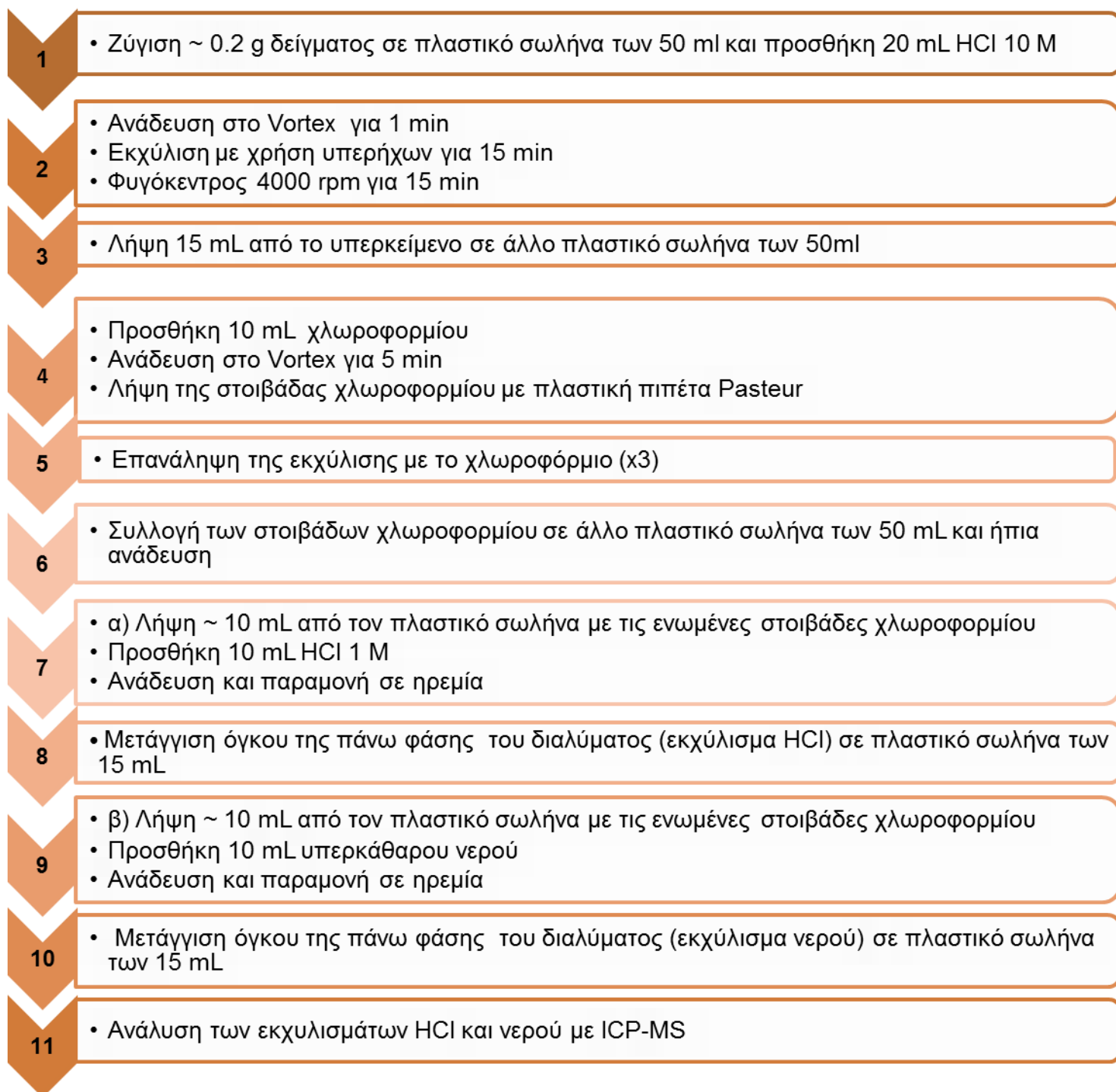
Σχήμα 8: Διάγραμμα ροής της πειραματικής διαδικασίας διφασικού συστήματος με υδροχλωρικό οξύ και χλωροφόρμιο
