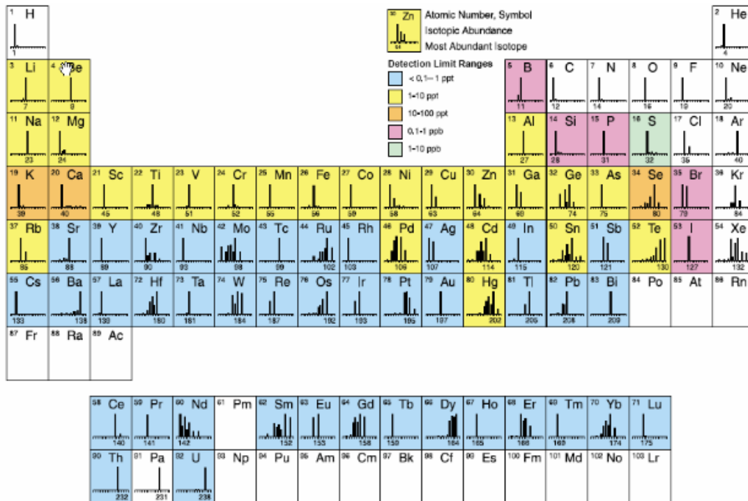
Εικόνα 2: Κάλυψη στοιχείων του περιοδικού πίνακα από την ICP-MS τεχνική [118].
