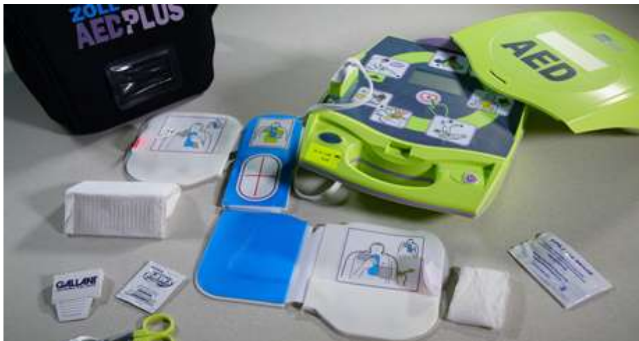
Εικόνα 1.15: Αυτόματος εξωτερικός απινιδωτής (ΑΕΑ)
