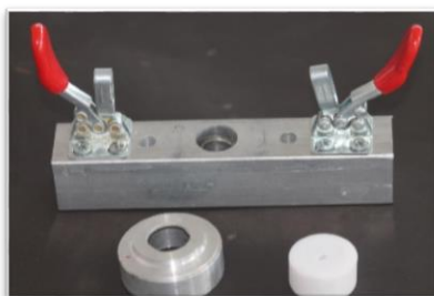
Εικ 3. Η ειδική συσκευή παραλληλισμού για την συγκόλληση των δοκιμίων
