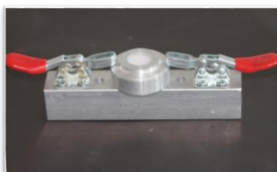
Εικ 3. Η ειδική συσκευή παραλληλισμού για την συγκόλληση των δοκιμίων
