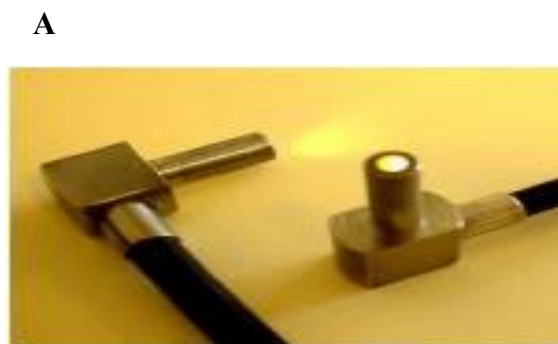
Εικόνα 3.4. Απεικόνιση (A) των οπτικών ινών NIRS και (B) της πλαστικής υποδοχής σταθεροποίησης των οπτικών ινών.
