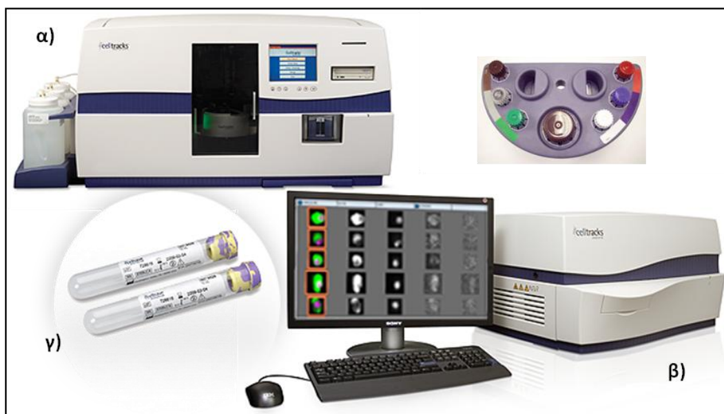
Σχήμα 4.5. Το σύστημα απομόνωσης και καταμέτρησης CTCs CellSearch®. α) Το σύστημα CELLTRACKS® AUTOPREP® και το CELLSEARCH® Circulating Tumor Cell Kit, β) το σύστημα CELLTRACKS ANALYZER II® και η έκθεση (gallery) εικόνων CTCs και γ) τα ειδικά σωληνάρια συλλογής περιφερικού αίματος CellSave Preservative Tubes ( http://www.cellsearchctc.com ).
