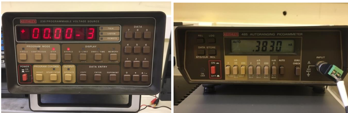
Εικόνα 3.3: Αριστερά τροφοδοτικό τάσης Keithley model 230 και δεξιά αμπερόμετρο Keithley model 485.
