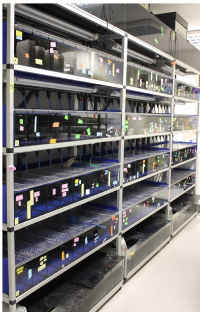
Εικόνα 3.1: Συστήματα ανακύκλωσης νερού του ενυδρείου στο ΙΙΒΕΑΑ. Στα συγκεκριμένα συστήματα, τα άτομα zebrafish διαβιούν σε δοχεία των 10L. Κάθε δοχείο φέρει μια αυτοκόλλητη
