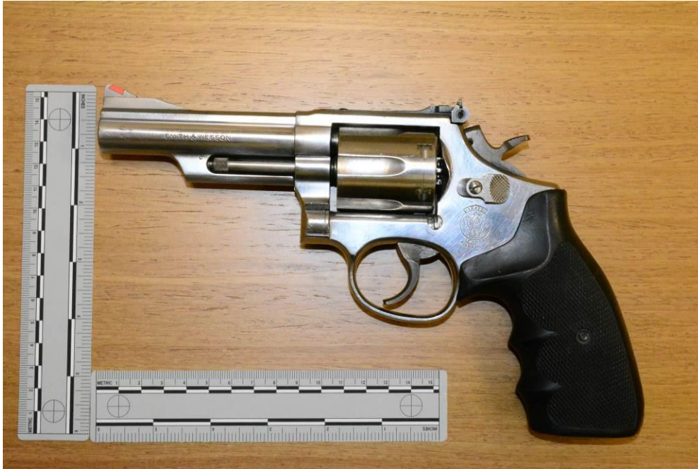
Εικόνα 1.13 Περίστροφο "SMITH & WESSON", Αμερικανικής κατασκευής (της εταιρίας "Smith & Wesson, Springfield MA. U.S.A."), μοντέλο "66-4", διαμετρήματος .357 Magnum. Έχει κάννη, που φέρει πέντε δεξιόστροφες (5R) ραβδώσεις - αυλακώσεις στο εσωτερικό της.
