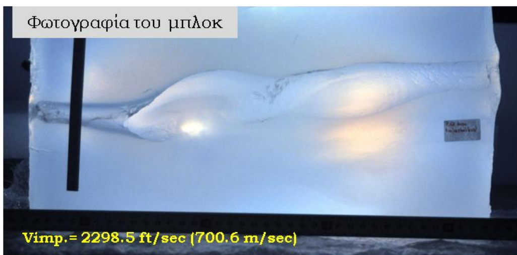
Εικόνα 7.3.21 Δεδομένα των δύο βολών με βολίδα (FMJ) 124gr, διαμετρήματος (Cal.) 7.62mm Kalashnikov (7.62X39mm). Φωτογράφιση των μπλοκ.
