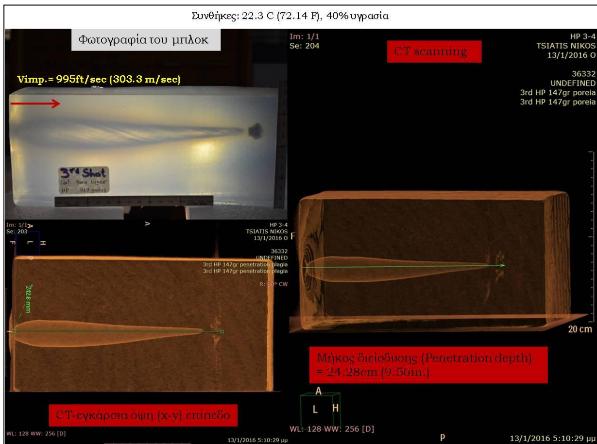
Εικόνα 7.3.9 Δεδομένα βολής με βολίδα HP 147gr. Φωτογράφιση του μπλοκ και απεικονίσεις τροχιάς από τον αξονικό τομογράφο.
