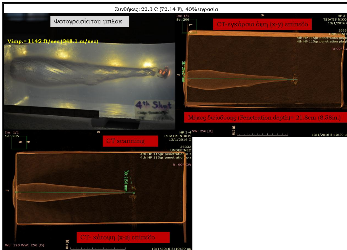
Εικόνα 7.3.10 Δεδομένα βολής με βολίδα HP 115gr. Φωτογράφιση του μπλοκ και απεικονίσεις τροχιάς από τον αξονικό τομογράφο.
