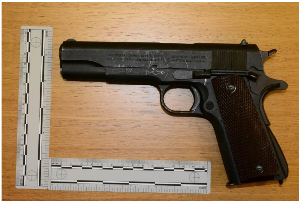
Εικόνα1.4 Πιστόλι "Colt", Αμερικανικής κατασκευής (της εταιρίας "COLT'S PT.F.A.MFG. CO., HARTFORD.CT. U.S.A."), διαμετρήματος .45ACP (.45 Auto), μοντέλο "M1911A1". Χρησιμοποιήθηκε ως το κύριο ατομικό όπλο των αξιωματικών του Ελληνικού Στρατού, για πολλές δεκαετίες. Η κατασκευή του ξεκίνησε τις αρχές του 20 ου αιώνα. Τρία (3) παρόμοιου τύπου πιστόλια, χρησιμοποιήθηκαν από τα μέλη της τρομοκρατικής οργάνωσης «17 Νοέμβρη», που έδρασε στην χώρα μας από τον Δεκέμβριο του 1975 έως τον Ιούνιο του 2002. Ένα εξ' αυτών, χρησιμοποιήθηκε σε
