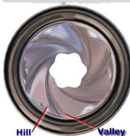
hill: ράβδωση (ύψωμα) valley: αυλάκωση (γραμμή αύλακος)
