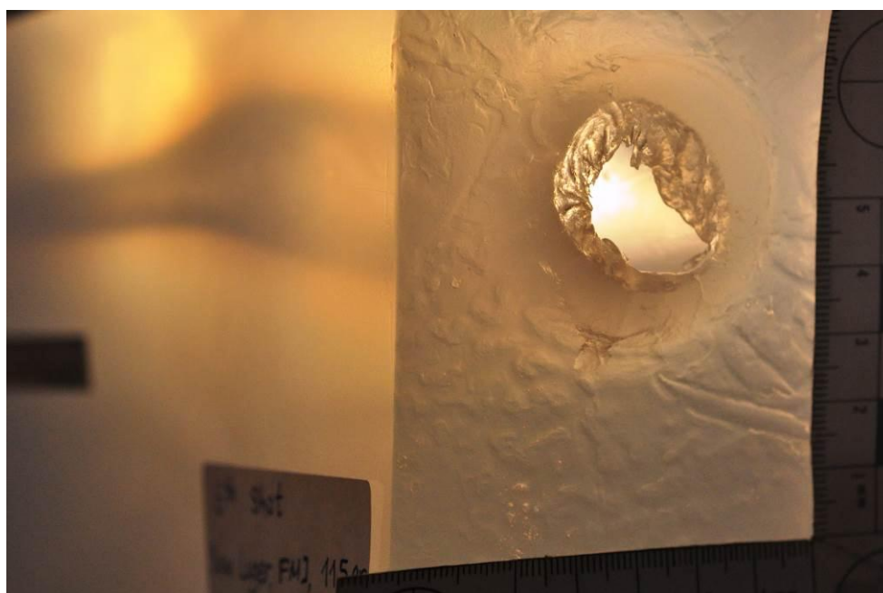
Εικόνα 8.5.14 Μορφολογία πύλης εξόδου που προκάλεσε βολίδα διαμετρήματος 9mm Parabellum, τύπου FMJ 115gr, σε υλικό τύπου "ballistic soap", με ταχύτητα εισόδου V_{imp}=369 m/sec.
