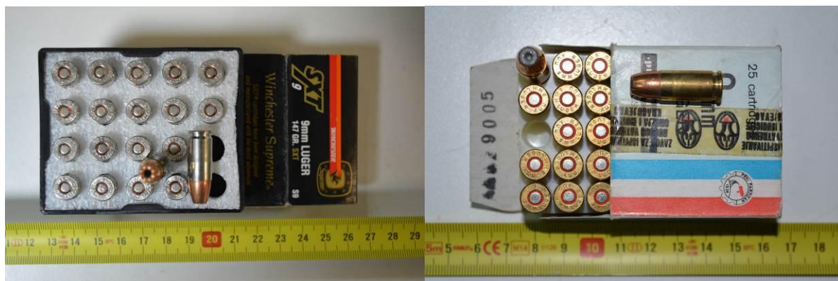
Εικόνες 8.5.9 Φυσιγγία (πυρομαχικά) διαμετρήματος (Cal.) 9mm Parabellum, με βολίδες HP 147gr (αριστερά) και βολίδες τύπου HP 115gr (δεξιά).
