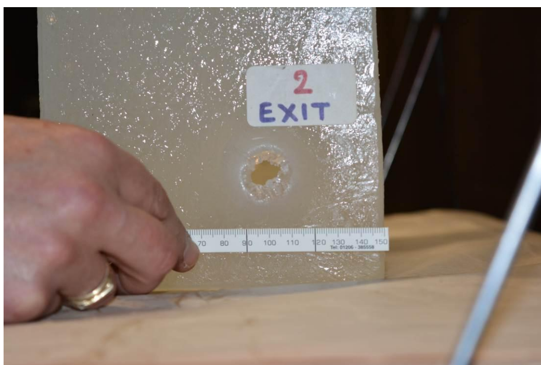
Εικόνες 8.5.8 Απεικονίσεις από τη μορφολογία που παρουσίασαν η πύλη εισόδου και η αντίστοιχη πύλη εξόδου που προκάλεσε βολίδα διαμετρήματος 9mm Parabellum, τύπου FMJ 115gr, σε υλικό τύπου "ballistic soap".
