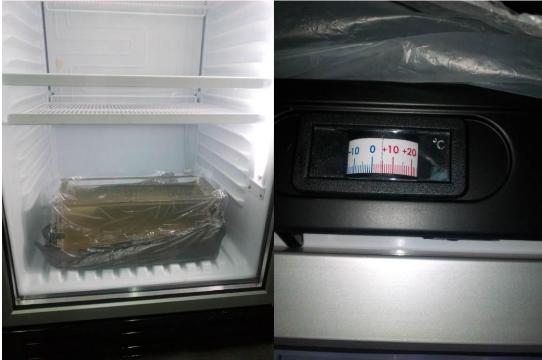
Εικόνες 7.4.3 Τοποθέτηση του εκμαγείου στο ψυγείο σε θερμοκρασία 4°C.
