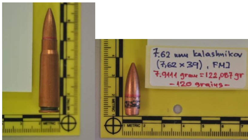
Εικόνες 7.3.20 Πυρομαχικό (φυσίγγιο), με επενδεδυμένη (FMJ) βολίδα, με ασάλινο πυρήνα (steelcore) 124 grains.
