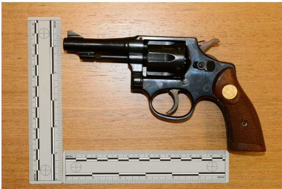
Εικόνα 1.16 Περίστροφο "Beretta", κατασκευής Βραζιλίας (για την εταιρία "Pietro Beretta S.p.A."), διαμετρήματος .32 S&W Long. Η κάννη του φέρει στο εσωτερικό της έξι δεξιόστροφες (6R) ραβδώσεις - αυλακώσεις.
