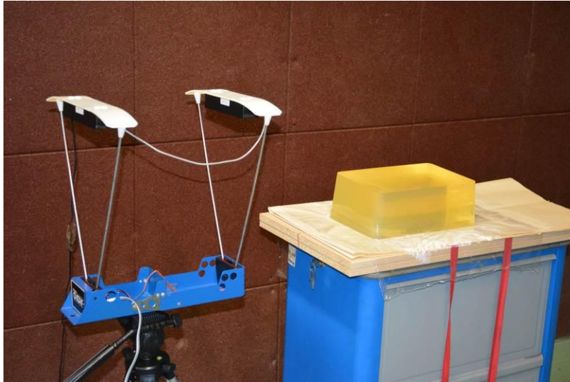
Εικόνα 7.4.9 Χρονογράφος 'ShootingChrony' τοποθετημένος πριν την είσοδο του βλήματος στο μπλοκ.
