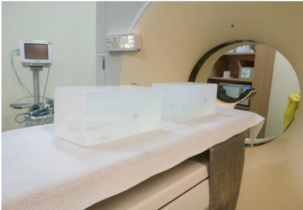
Εικόνα 7.3.1 Διαδικασία τοποθέτησης – εισαγωγής δύο εκμαγείων (μπλοκ) "ballistic soap" στον αξονικό τομογράφο "Philips Brilliance 64".
