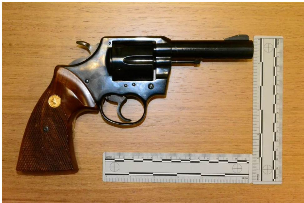
Εικόνα 1.17 Περίστροφο "Colt", Αμερικανικής κατασκευής (της εταιρίας "COLT`SPT.F.A.MFG. CO., HARTFORD.CT. U.S.A."), μοντέλο "PYTHON 357", διαμετρήματος .357Magnum.
