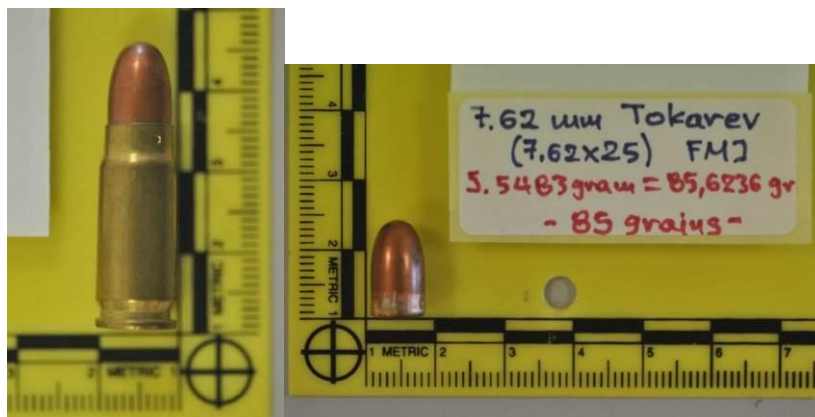
Εικόνες 7.3.16 Πυρομαχικό (φυσίγγιο) με επενδεδυμένη (FMJ) βολίδα, 85 grains.
