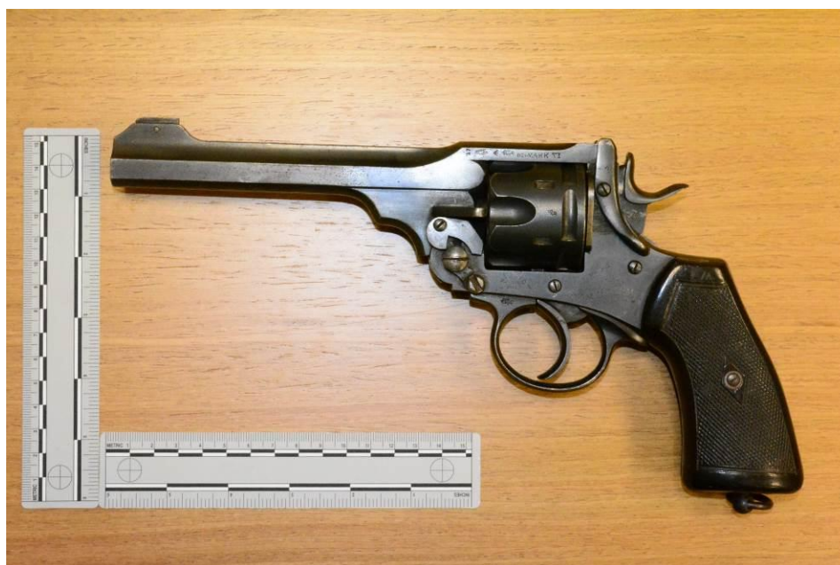
Εικόνα 1.18 Περίστροφο τύπου "Hinged Frame", Βρετανικής κατασκευής, μοντέλο "MKVI", διαμετρήματος .455 Webley Mk VI (11.55×19.3mmR). Πρόκειται για παλαιού τύπου περίστροφο στο οποίο, για την τροφοδοσία του (γέμιση ή απογέμιση) το βυκίο του «απελευθερώνεται» διά κάμψεως της κάννης του όπλου, καθώς είναι ενσωματωμένο με το εμπρόσθιο τμήμα του κορμού. Η κατασκευή του ξεκίνησε το 1939 και χρησιμοποιήθηκε κυρίως κατά τη διάρκεια του Β' Παγκοσμίου Πολέμου. Το
