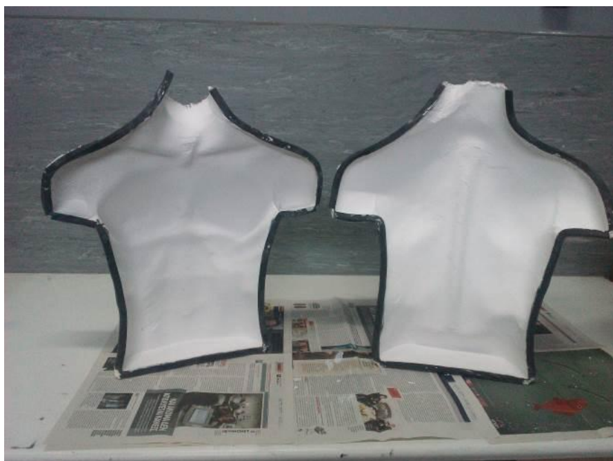
Εικόνες 10.6.2 Κατασκευή εκμαγείου σε δύο τμήματα, τα οποία θα ενωθούν και συγκολληθούν, προκειμένου να χυτευθεί το υλικό του μίγματος.
