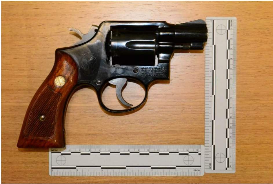
Εικόνα 1.15 Περίστροφο "SMITH & WESSON", Αμερικανικής κατασκευής (της εταιρίας "Smith & Wesson, Springfield MA. U.S.A."), μοντέλο "12-2", διαμετρήματος .38 SPL. Έχει κάννη, που φέρει πέντε δεξιόστροφες (5R) ραβδώσεις - αυλακώσεις στο εσωτερικό της.
