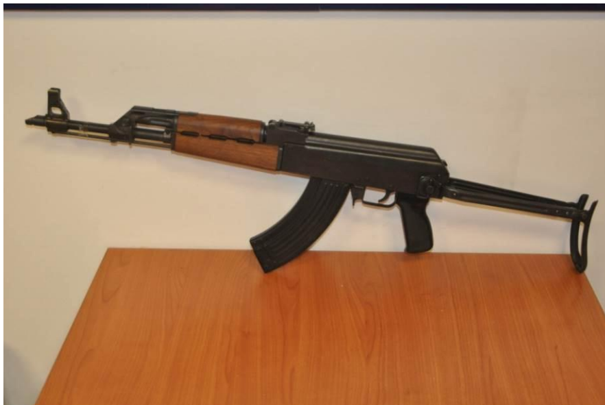
Εικόνα 7.3.19 Πολεμικό τυφέκιο (assault Rifle) τύπου Kalashnikov, μοντέλο AK47, διαμετρήματος (Cal.) 7.62mmKalashnikov (7.62X39mm).
