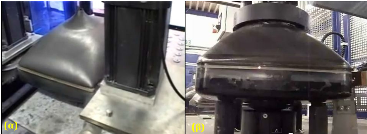
Σχήμα 2.22. (α) Αποκόλληση του λαιμού από το πάνελ με μηχανικό τρόπο (αδαμαντοτροχοί), (β) Αποκόλληση με τήξη μέσω θερμαινόμενου σύρματος (λεπτή γκρίζα ταινία που περιβάλλει το CRT )
