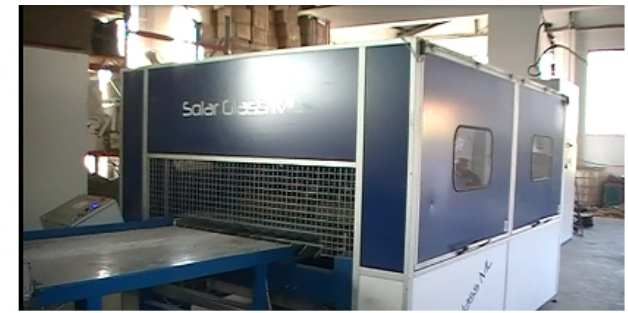
Εσωτερική τράπεζα και είσοδος των τεμαχίων στο μηχάνημα θραύσης του γυαλιού.
