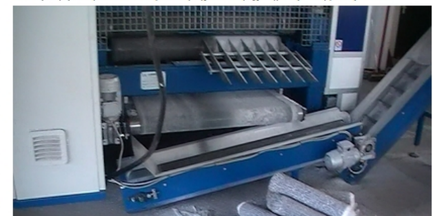
Ταινιοδρόμος μεταφοράς του γυαλιού σε συλλογέα.
