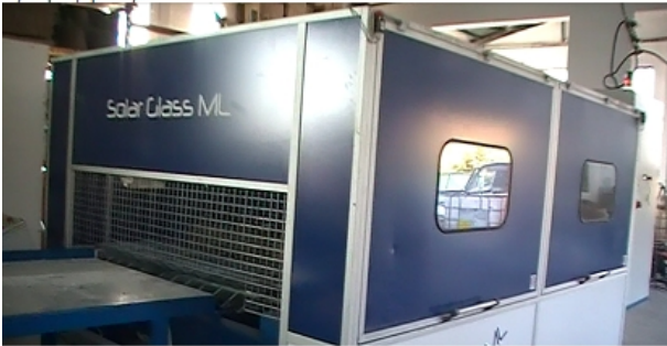
Στόμιο εισόδου στο μηχάνημα θραύσης του γυαλιού.
