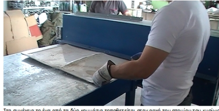
Στη συνέχεια το ένα από τα δύο κομμάτια τοποθετείται στην αρχή του στομίου του κυρίως μηχανήματος και οι κύλινδροι τίθενται σε λειτουργία.
