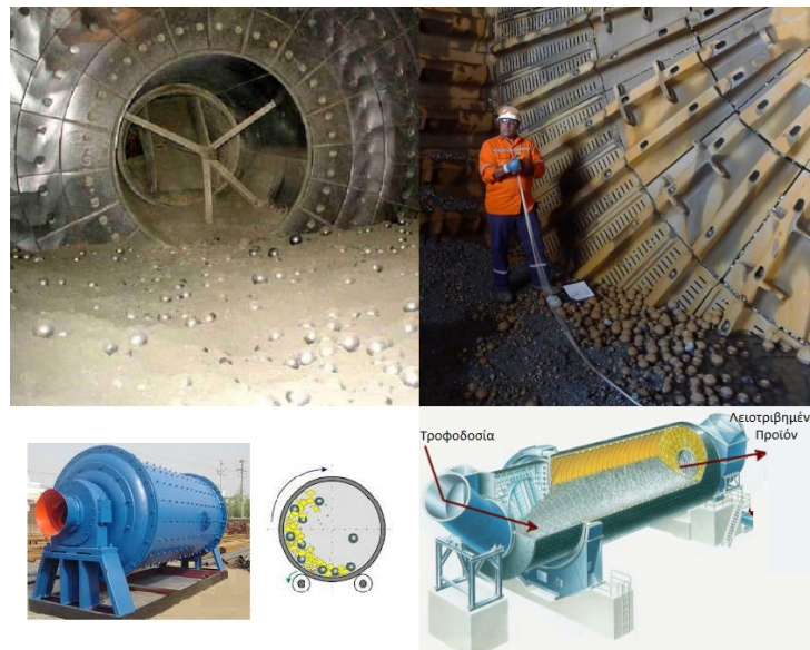
Σχήμα 2.7. Σφαιρόμυλοι και σχηματική περιγραφή της αρχής λειτουργίας τους (google.com)
