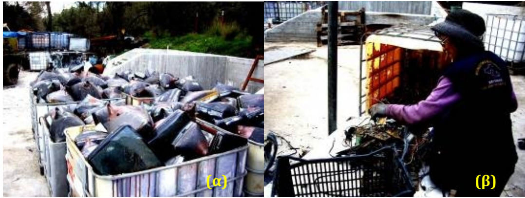
Σχήμα 4.2. (α) Καθοδικοί σωλήνες από οθόνες CRT, αποσυναρμολογημένοι και τοποθετημένοι σε παλλετοδεξαμενές, (β) Χειρωνακτική αφαίρεση καλωδίων από ολοκληρωμένα κυκλώματα τηλεοράσεων CRT
