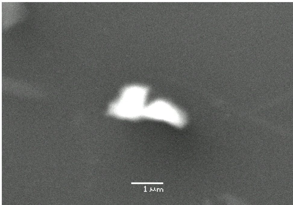
Σχήμα 5.55. Δείγμα REC-1 (λεπτομέρεια μεταλλικού ψήγματος (Fe))
