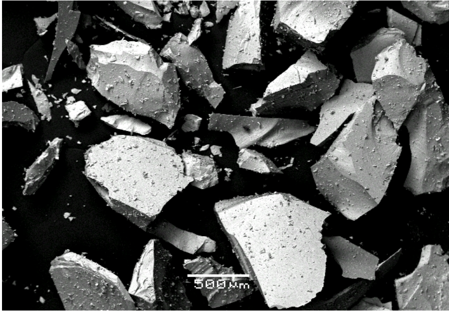
Σχήμα 5.54. Δείγμα REC-1 (κόκκοι υάλου με ψήγματα μεταλλικών στοιχείων)
