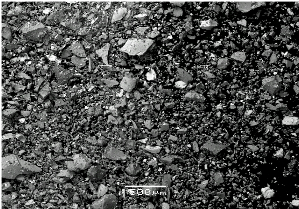
Σχήμα 4.16. Δείγμα TNK - 2 (ίζημα από δεξαμενή καθίζησης)
