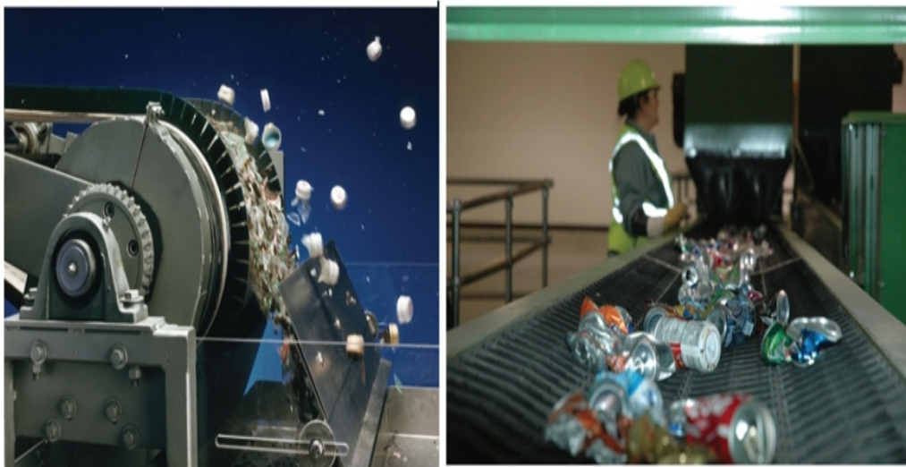
Σχήμα 2.17. Αρχή λειτουργίας Eddy Current (Steinert)
