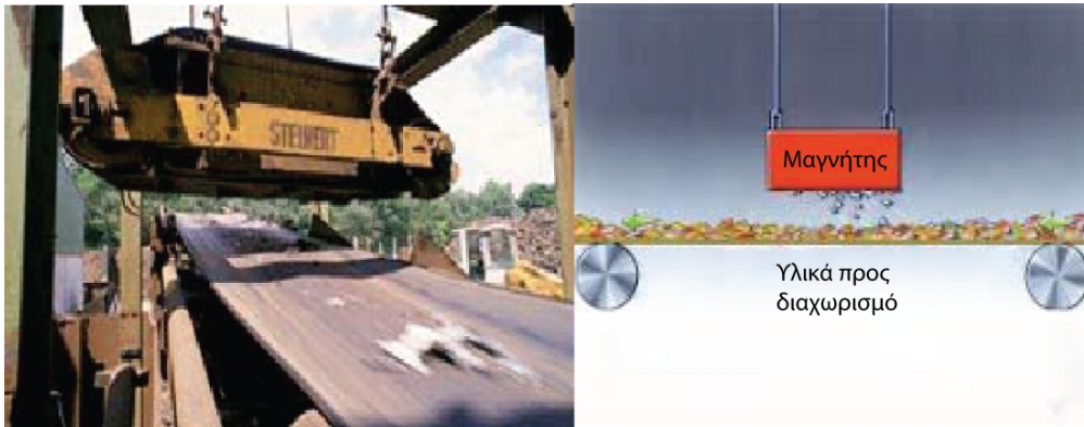
Σχήμα 2.15. Μαγνητική ταινία (Steinert)
