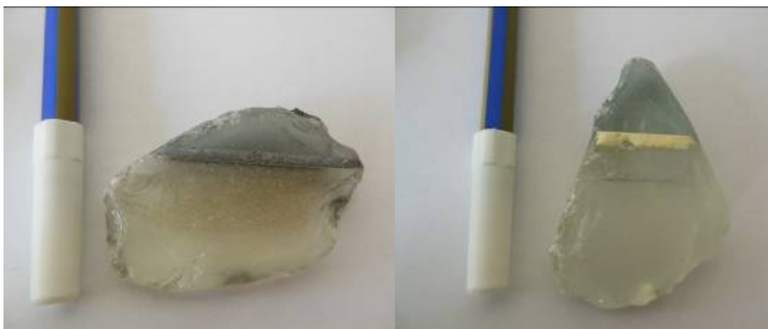
Σχήμα 4.5. Τεμάχια γυαλιού οθόνης CRT με εμφανή μετάβαση από το μπροστινό προς το πίσω μέρος (χοάνη)
