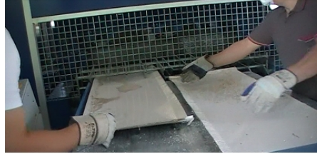
Στη συνέχεια το ένα από τα δύο κομμάτια τοποθετείται στην αρχή του στομίου του κυρίως μηχανήματος και οι κύλινδροι τίθενται σε λειτουργία.
