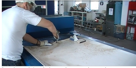
Στη συνέχεια το πάνελ τοποθετείται στο στάδιο του μηχανήματος κοπής
