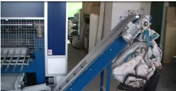
Ταινιοδρόμος μεταφοράς και φόρτωσης του γυαλιού σε συλλογέα (μπικ μπραγκ)
