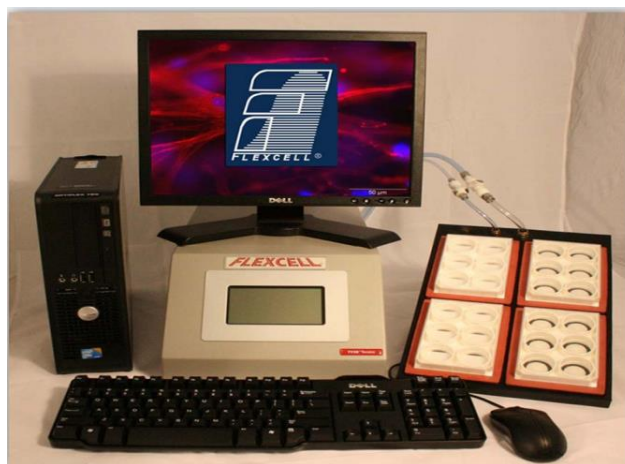
Εικόνα 1: Flexcell® FX-5000™ Tension System. Βιοαντιδραστήρας που ρυθμίζεται από υπολογιστή και χρησιμοποιεί πίεση κενού για την εφαρμογή κυκλικής ή στατικής επιμήκυνσης σε κύτταρα που καλλιεργούνται σε επιφάνειες καλλιέργειας με εύκαμπτο πυθμένα.
