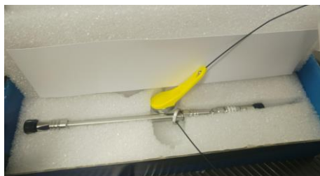
Σχήμα 4.7 Χρωματογραφική στήλη UPLC
