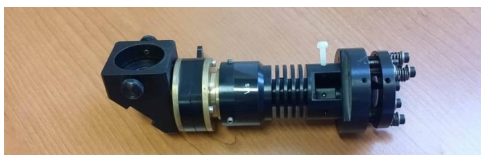
Σχήμα 4.8 Εξάρτημα τοποθέτησης κυψελίδας για ανάλυση υγρού δείγματος
