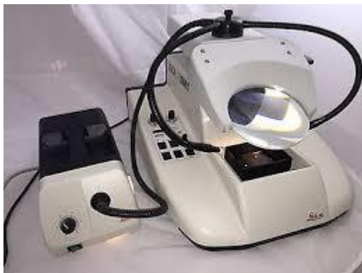
Εικόνα 15 Η μικροτόμος δονούμενης λεπίδας
