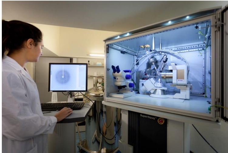
Εικόνα 2.3. Συμβατική γεννήτρια ακτίνων Χ, υποδομή εγκατεστημένη στο Ινστιτούτο Βιολογίας, Φαρμακευτικής Χημείας και Βιοτεχνολογίας του Εθνικού Ιδρύματος Ερευνών.
